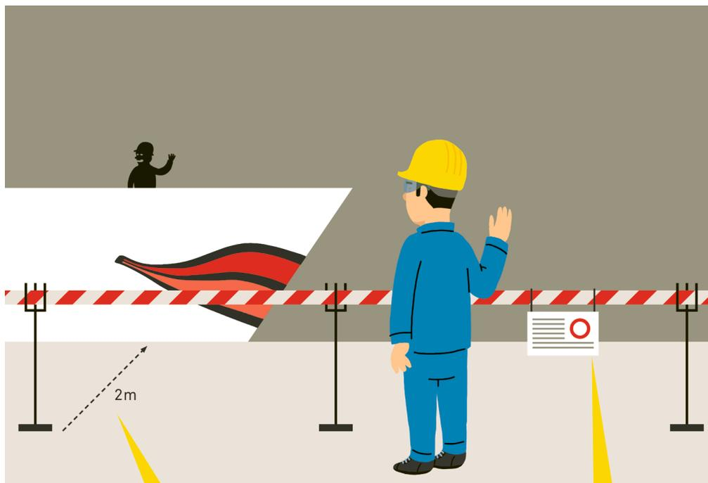
Protezione provvisoria del bordo di caduta a rischio con nastro segnaletico o catena ad una distanza di almeno 2 m!
